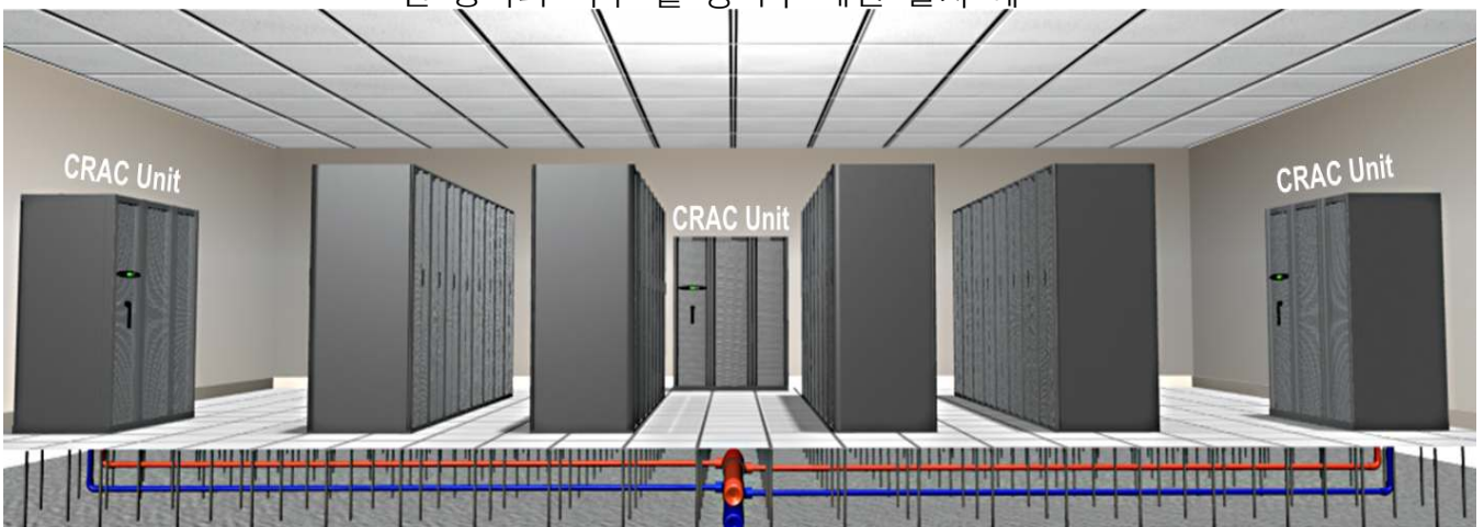
그림 1 – 다수의 피팅을 사용해서 다수의 에어컨으로 연결되고 있는 전통적인 방식의 마루 밑 냉각수 배관 설치 예
