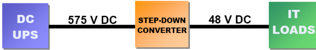
그림 1-e : 가상의 혼성 DC 575V 전원 분배
